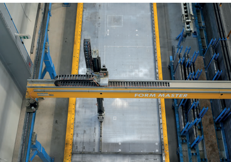
Die Schalungselemente werden nach der CAD-Planung präzise und automatisiert eingelegt.
