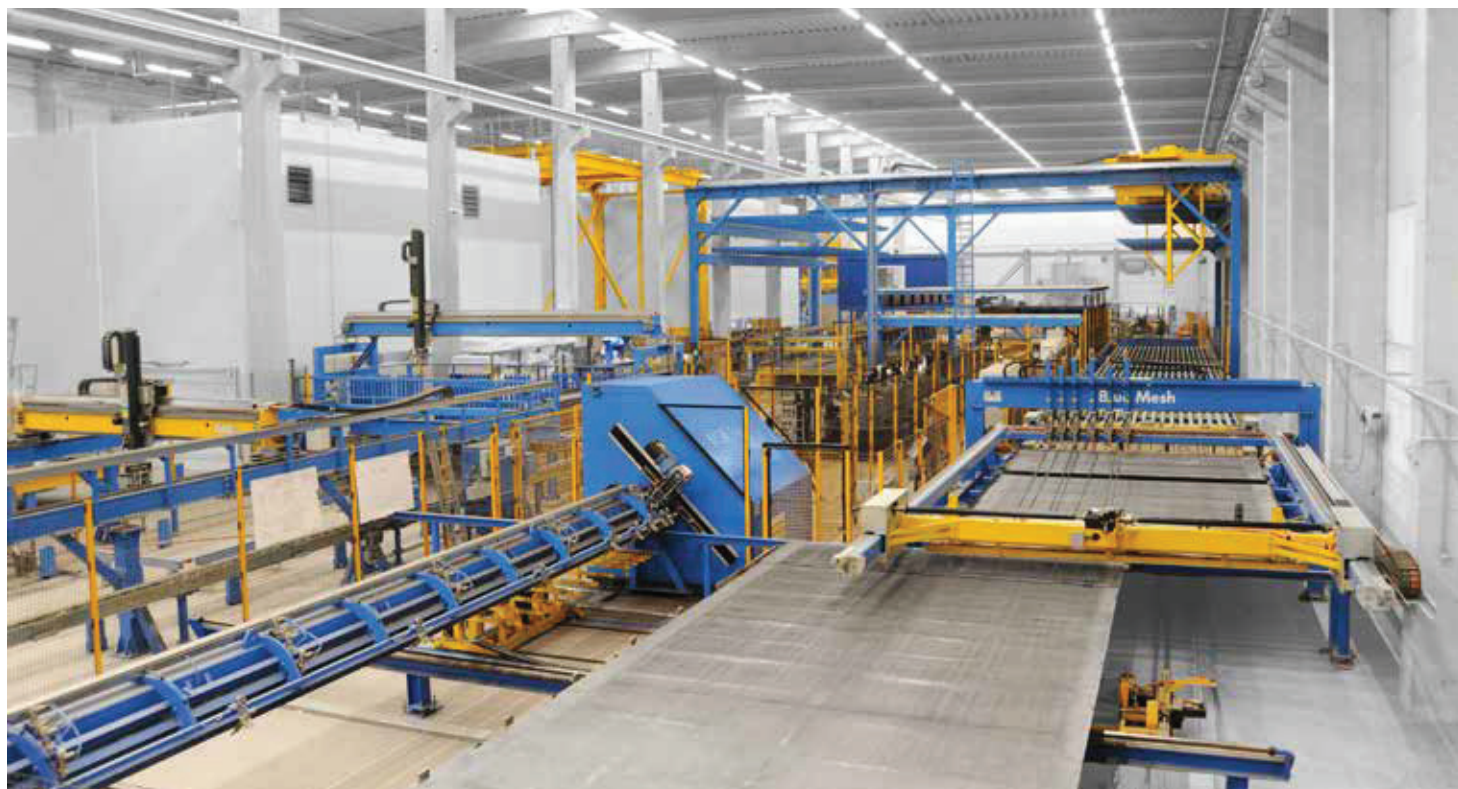
The BlueMesh mesh welding plant and VGA Versa lattice girder welding machine form part of the impressive, fully automated reinforcement area Der komplett automatisierte Bewehrungsbereich besticht mit Mattenschweißanlage BlueMesh und Gitterträgerschweißmaschine VGA Versa
