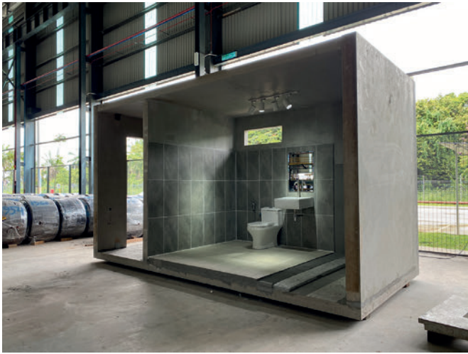
IJM IBS PPVC: Vorgefertigt und vollständig mit architektonischen Oberflächen versehen, bereit für eine effiziente Lieferung an die Baustelle
