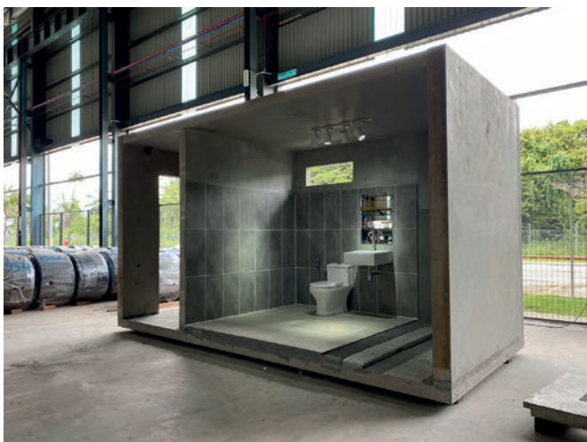
IJM IBS PPVC: prefabbricata e dotata completamente delle superfici architettoniche, pronta per una consegna efficiente in cantiere.
