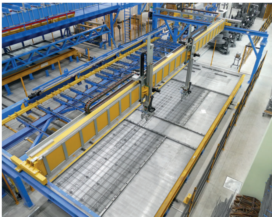
Ein Mehrachsen-Linearroboter rundet den automatisierten Bewehrungsbereich im neuen Werk von Eder ab.
