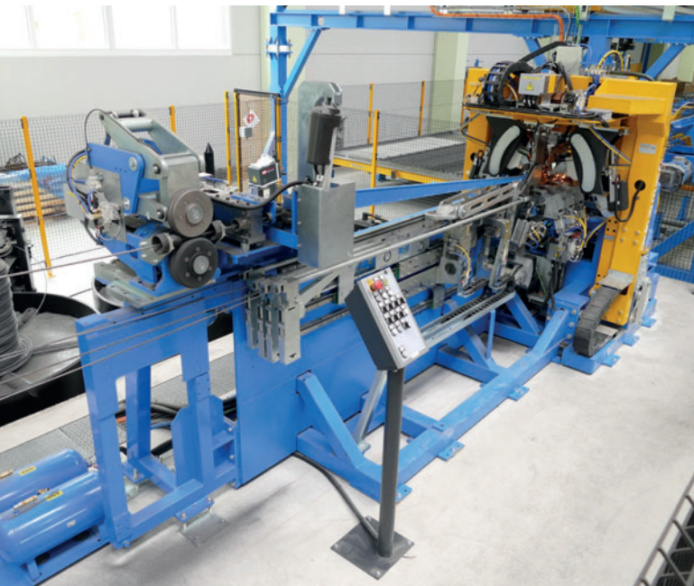
Гибкая машина для сварки решетчатых балок VGA Versa изготавливает армокаркасы «точно в срок», что дает компании Eder большой потенциал экономии в области расходов на логистику, складское хранение и раскрой
