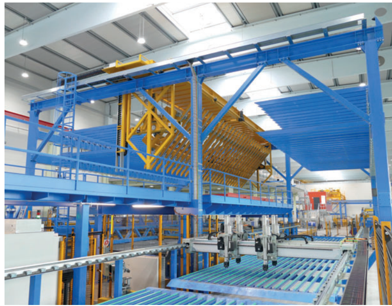
Магнитная траверса укладывает арматурные сетки на паллеты в соответствии с данными САПР, обслуживает накопитель промежуточного хранения, поворачивает сетки, если продольные прутки должны располагаться над поперечными прутками, и укладывает арматурные сетки на штабелер
