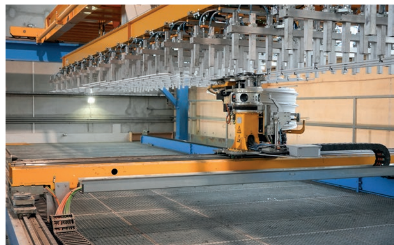
Der Rohrverlegeroboter Tube Master ermöglicht die automatische Verlegung von Heiz- und Kühlrohren in Betonfertigteilen.
