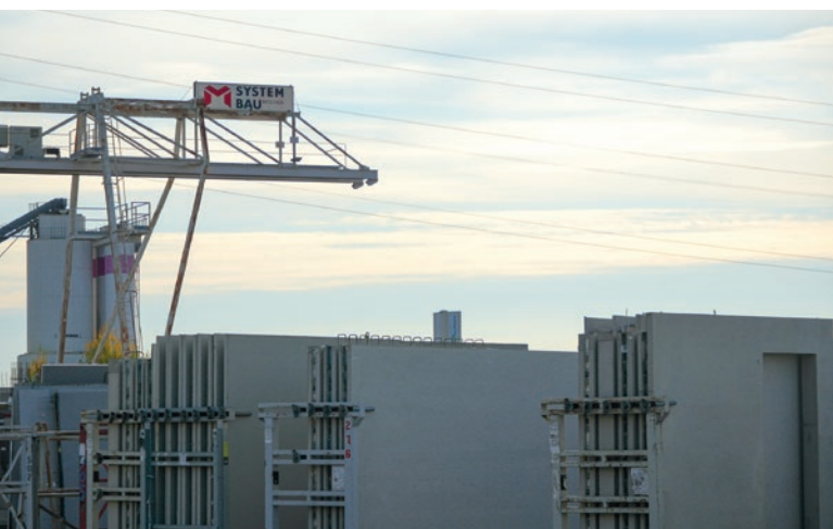
Betonfertigteile von Mischek Systembau vor dem Transport auf die Baustelle
