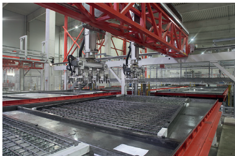
Решетчатые балки и арматурные стержни точно размещаются на поддонах с помощью захватов
