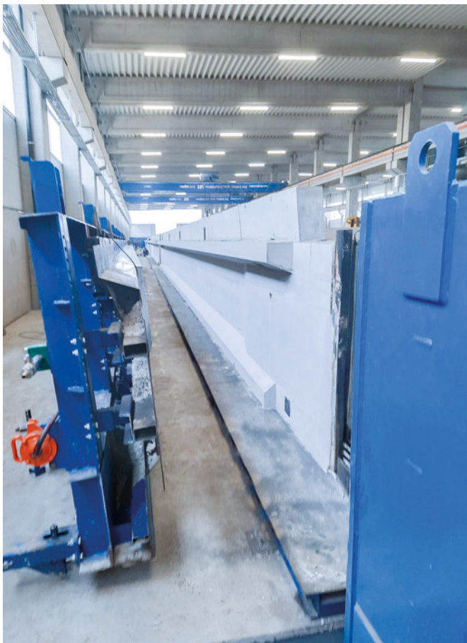
Die besonders anpassungsfähige Schalung für I-Träger ist 32 m lang und kann qualitativ hochwertige Träger für mittlere und große Industriegebäude herstellen.
