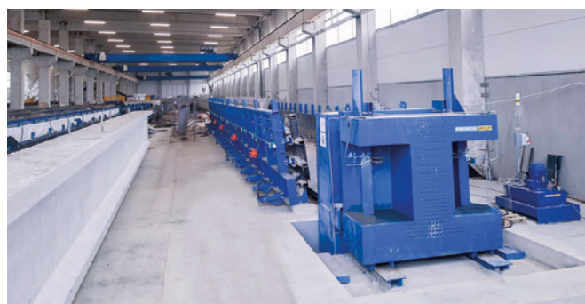
Die Schalung für Träger mit Widerlagern erleichtert die Herstellung nach Kundenwunsch.
